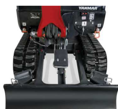
Zwężone podwozie : 980 mm
