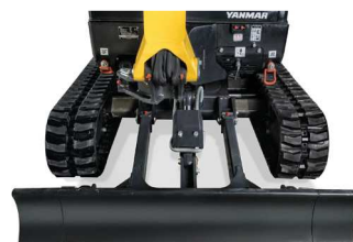
Rozszerzone podwozie: 1320 mm
